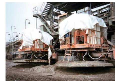
Obří tlapy umožňující pohyb důlního pontonu
